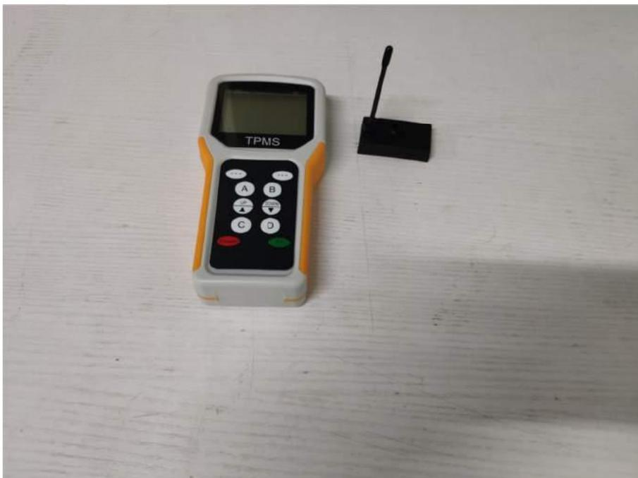
图30 测试后检查（自由跌落）
