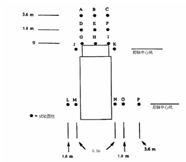
图C.1 视野检验中检验圆柱体的位置
