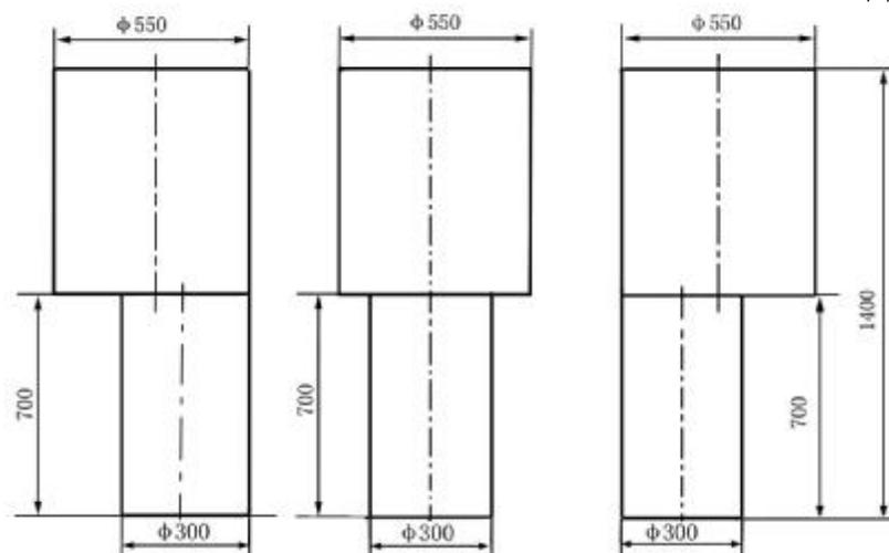
上圆柱直径可在顶部减为 400mm，其过渡斜面与水平面夹角不超过 30°。
